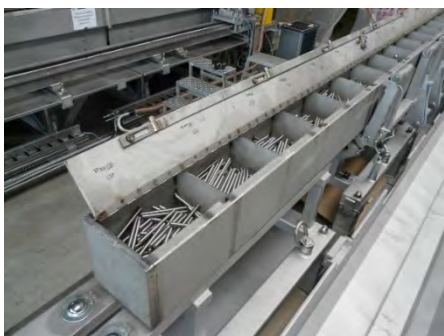
Bild 3: Etui mit kurzen Stäben in hydraulischer Kippvorrichtung
