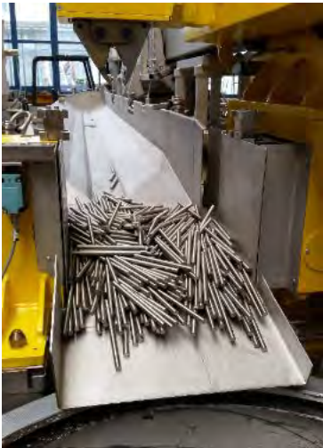
Bild 5: kurze Stäbe am Ende des Rüttelprozesses
