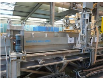
Bild 9: Säge und Zufuhrinheit der Etuizerlegelinie
